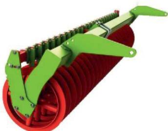
Un rouleau d'un diamètre de 500 mm, avec des propriétés correspondant à un rouleau v-ring doté de sections d'anneaux en T. Compacte la terre en bandes. Il fonctionne parfaitement sur les sols grumeleux en raison du profil aiguisé de ses anneaux. Également sur ce rouleau, une section de longs racleurs est montée pour nettoyer les espaces entre les anneaux.
