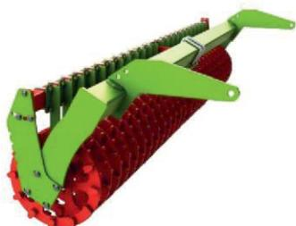
Il fonctionne très bien pour briser les sols grumeleux. Il laisse une bande de sol à structure meuble et empêche ainsi la formation d'une croûte à sa surface. La structure annulaire du rouleau le protège du colmatage. Le rouleau est parfait pour les sols légers. Le rouleau peut être configuré avec un système de racleurs longitudinaux nettoyant les espaces entre les anneaux.
