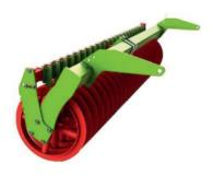
Eine Walze mit einem Durchmesser von 500 mm, deren Eigenschaften einem Dachschacht entsprechen, im Sektion aus T-Ringen gebaut. Verdichtet die Erde streifenweise. Aufgrund des aggressiven Profils dieser Ringe eignet es sich hervorragend für klumpige Böden. Auf dieser Welle ist außerdem ein Abschnitt mit langen Abstreifern montiert, um die Zwischenräume zwischen den Ringen zu reinigen.
